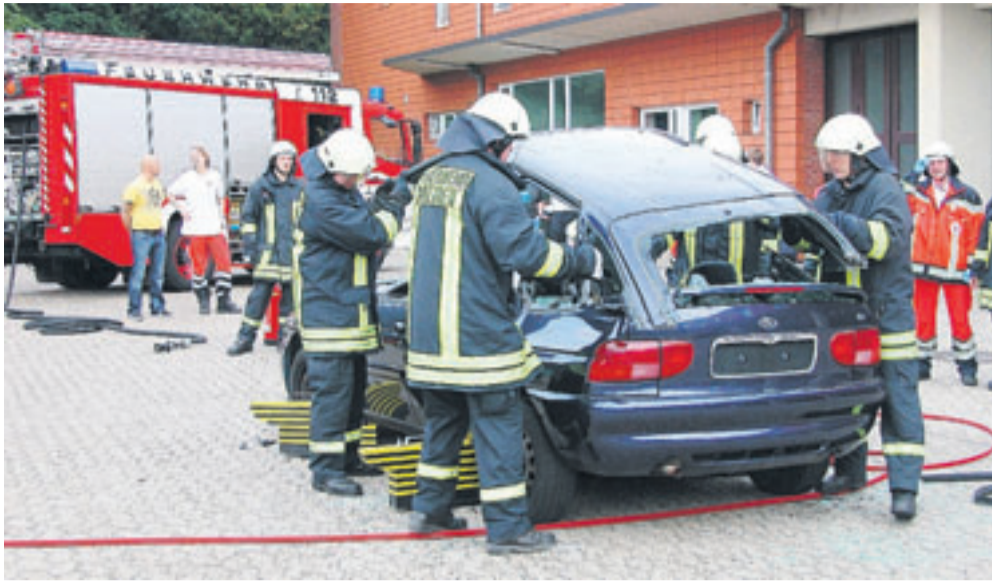
Die Muskeln gespannt, das Autodach gelöst: Nachdem die hydraulische Schere ganze Vorarbeit geleistet hat, können die Feuerwehrleute das Dach abnehmen. MSS-FOTOS: ASSMANN
